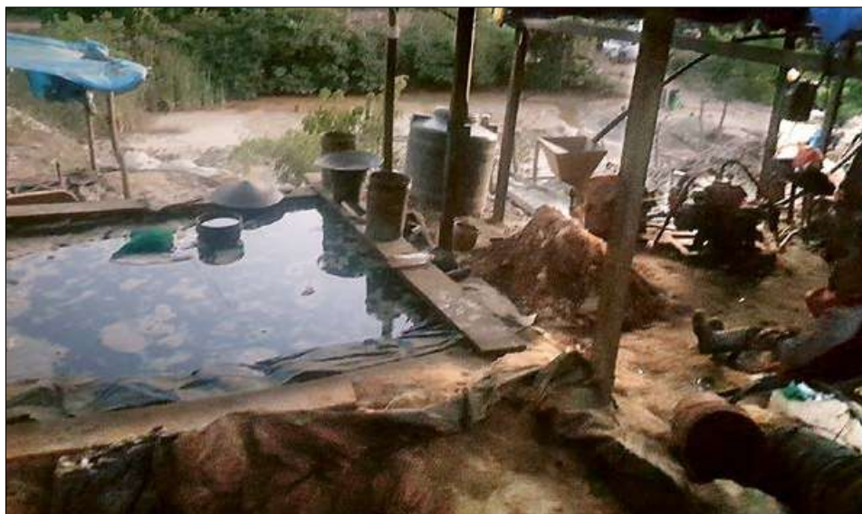
Foto 11 Piscina de depuración para obtener oro amalgamado.
