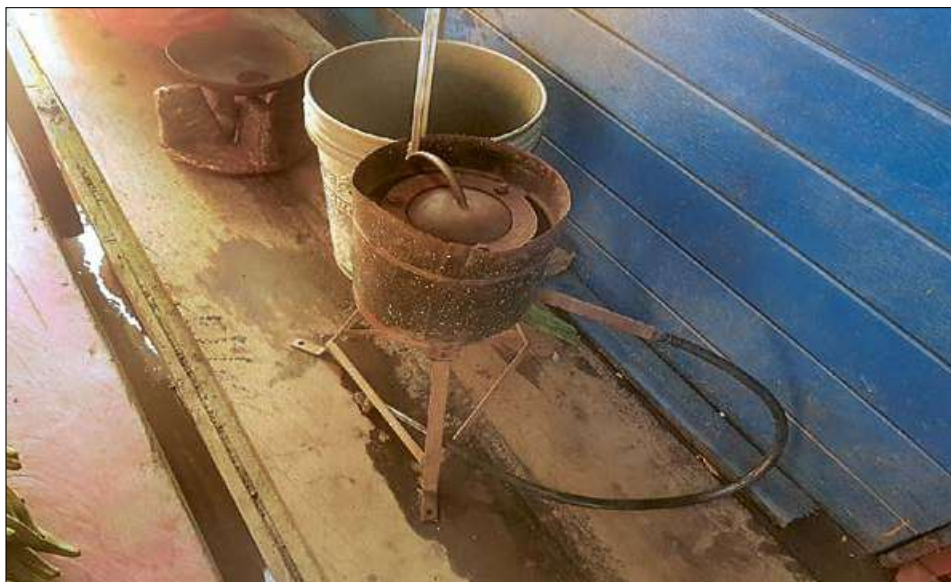
Foto 20 Equipo quemador de oro amalgamado-retorta (2019).
