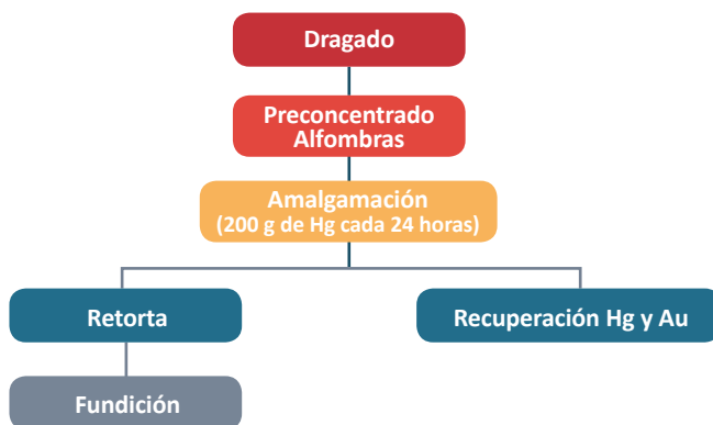
Figura 21 Proceso de concentración de mineral en la Balsa N° 1
