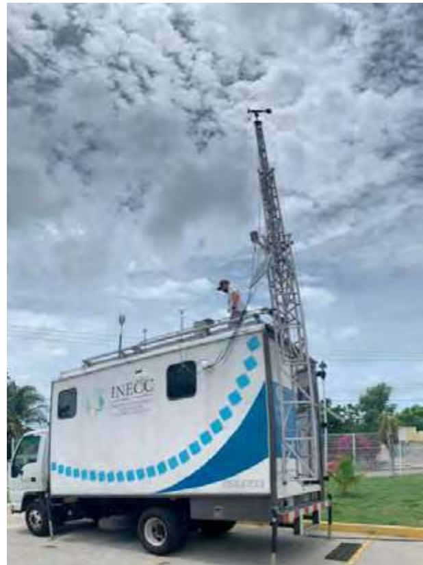
Laboratorio móvil para la medición de concentraciones de contaminantes criterio, INECC. Autor: Dr. José Abraham Ortiz Álvarez.
